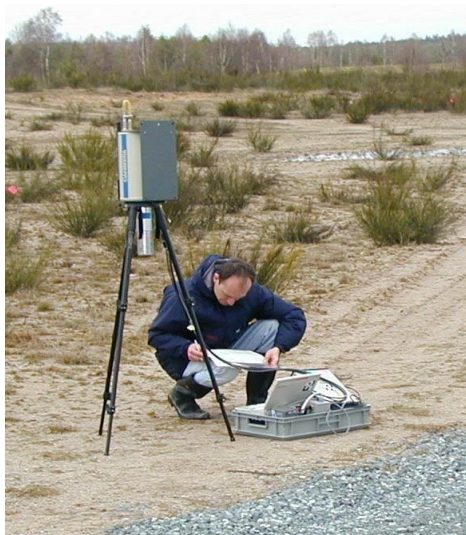
Abb. 3: In-Situ-Gamma-Spektrometrie auf dem Truppenübungsplatz Grafenwöhr durch das LfU
