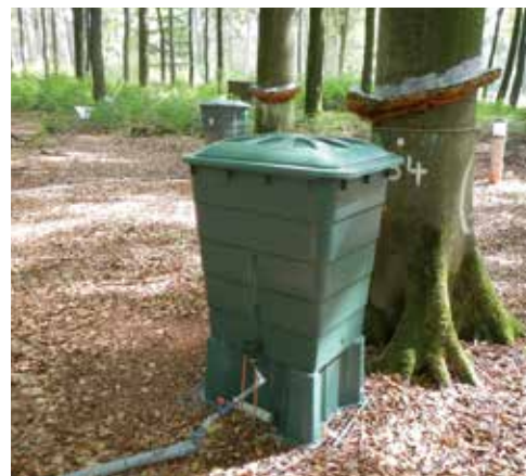
Stammabflussanlage an einer Buche
