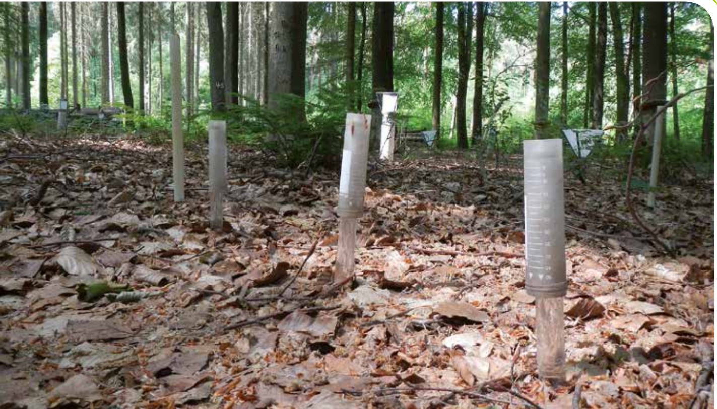
Tensiometer zur Messung der Bodenwasserspannung auf der Level-II-Fläche Haard
